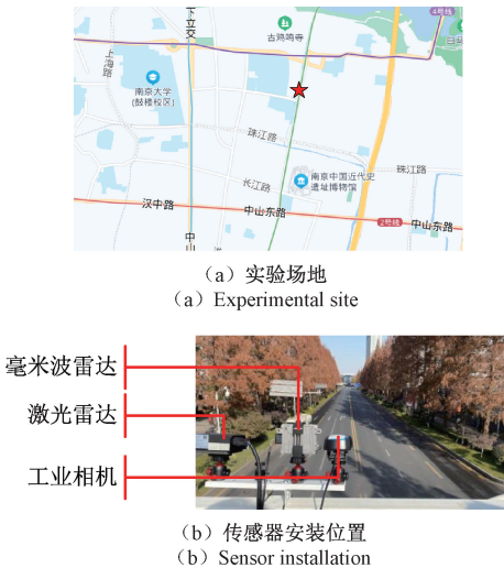
图 3 实验场地及传感器安装位置 Fig. 3 Experimental site and sensor installation
