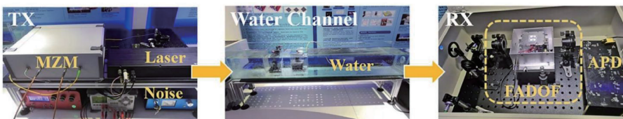
图 9 法拉第激光器与 FADOF 用于水下光通信实验装置图 [109]
