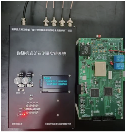
图2 发射系统样机实物及核心电路板
