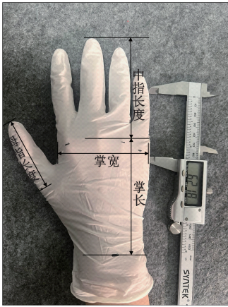
图 3 人手尺寸测量说明 Fig. 3 Instructions for measuring hand dimensions
